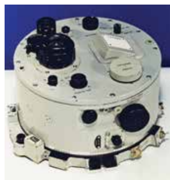
Бортовий секстант «Цель», створений на «Арсеналі» для місячного пілотованого комплексу
