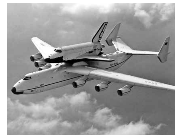
Транспортування багаторазового орбітального корабля «Буран» українським літаком Ан-225 «Мрія» на космодром Байконур
