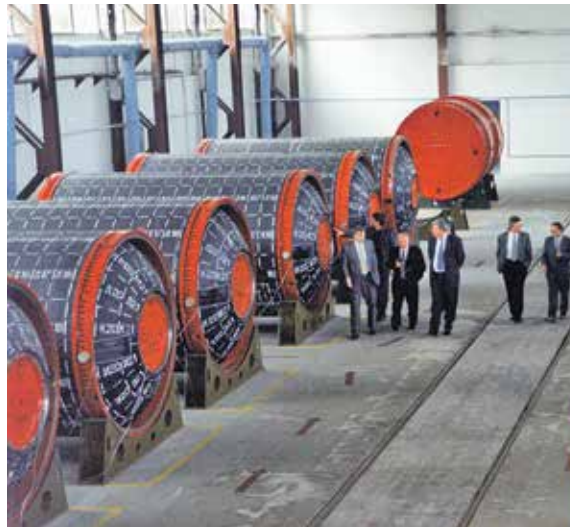
Сховище споряджених корпусів ракетних двигунів Storage of the loaded missile engine cases
