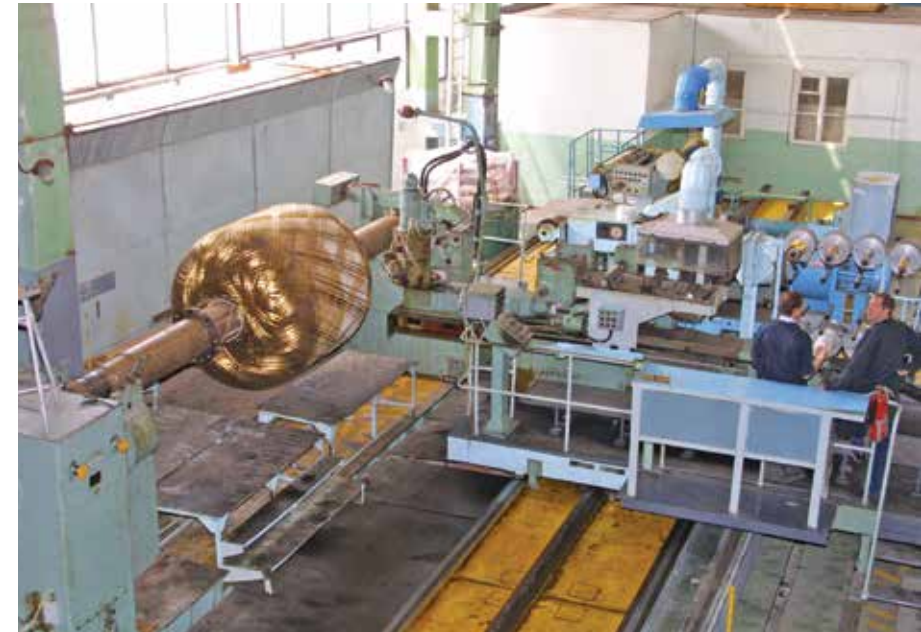
Виготовлення корпусу твердопаливного двигуна Manufacture of a casing for solid propellant rocket engine
